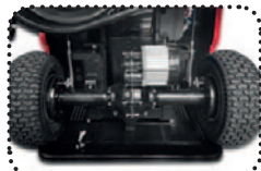
Uložení masivní zadní převodovky Weibang HEAVY-DUTY
